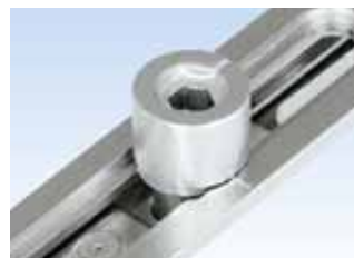
Запирающая цапфа Duplex с регулировкой прижима ( \pm 1 мм). Регулировка с помощью внутреннего шестигранника на 4 или 6 мм по выбору
